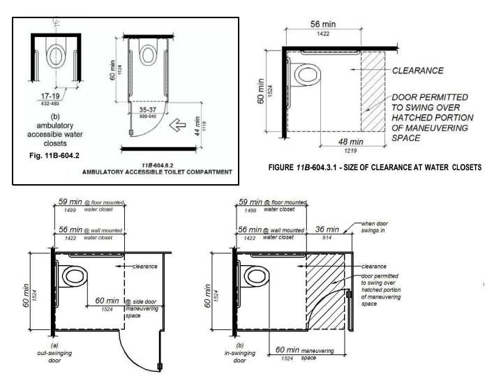
FIGURE 11B-604.8.1.1.2 - MANEUVERING SPACE WITH SIDE-OPENING DOOR
